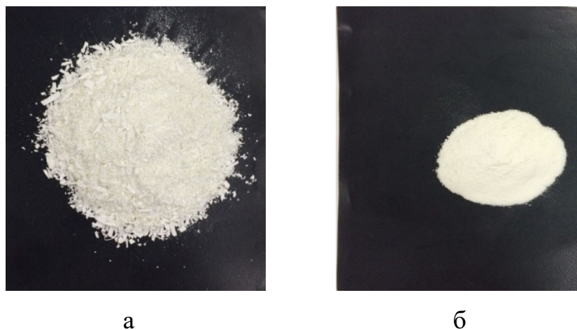
Рис. 47. Снимки некапсулированного (а) и капсулированного (б) образцов ПЭЭЖ (I) массами по 5 г.
