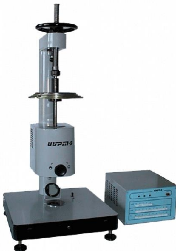
Рисунок 17 – Прибор для определения показателя текучести расплава
