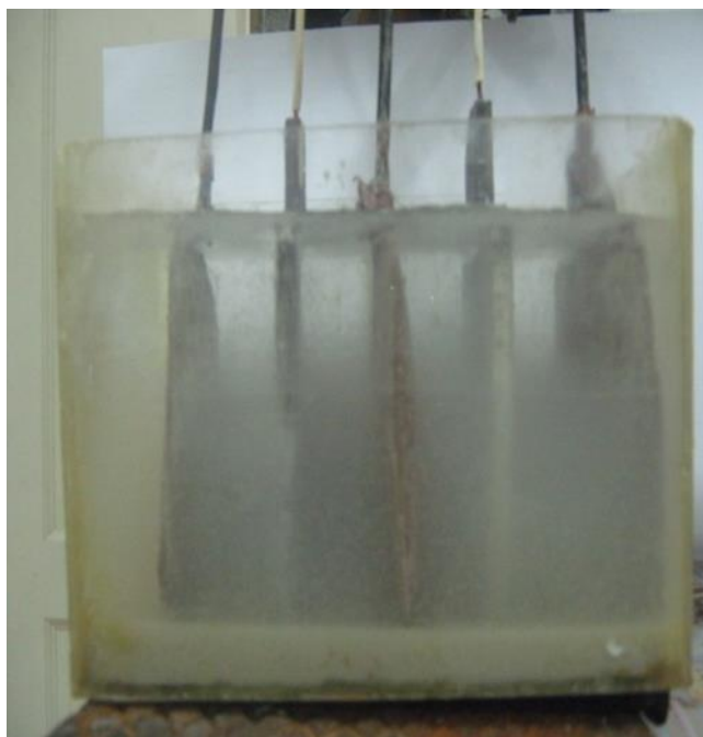
Рисунок 9 – Фотография конструкции 5-электродного электролизёра для получения бентонита-Э на двух свинцовых анодах.
