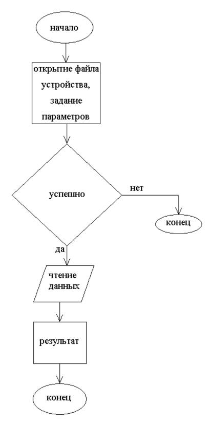
Рис. 2.12. Алгоритм управления звуковой картой.
