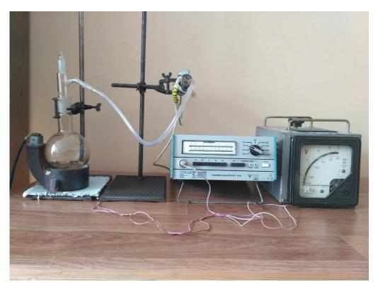
Рис.2.24. Внешний вид экспериментальной установки для обработки образцов водяным паром.
